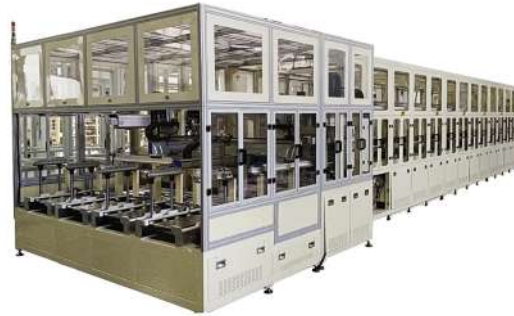
Şekil 28. Batarya sınıflandırma (sorting, grading) makinesi (Chipbest Dongguan Group firmasının ürün görselidir).
