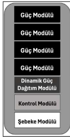
Şekil 2. Bir şarj güç ünitesi (kabin) iç yapısı.
