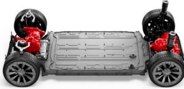
Şekil 10. Hücreden şasiye tasarımı Tesla Model X “skateboard” şasi mimarisi.
