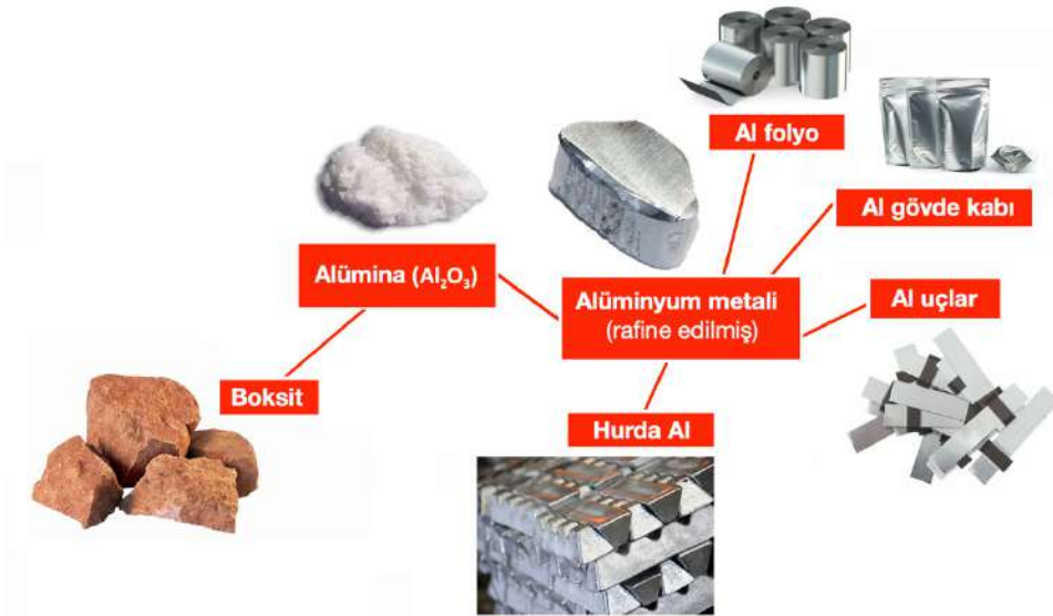
Şekil 15. Hücrelerde kullanılan alüminyum mamülleri ve öncülleri
