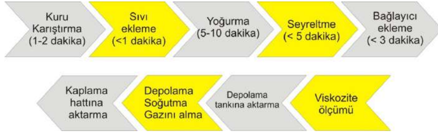
Şekil 5. Karıştırma sürecinin detaylı ve süreli aşamalarının şematik gösterimi.
