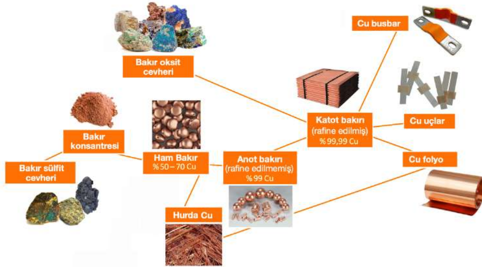
Şekil 14. Bataryalarda kullanılan bakır ürünler ve öncülleri
