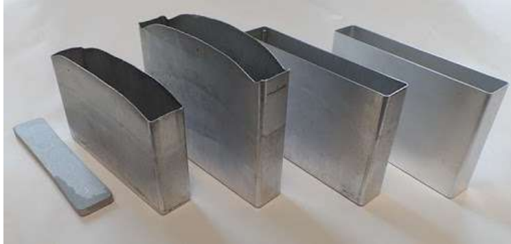
Şekil 18. Prizmatik hücre gövdesi üretim süreci (Int. Kyn. 13)
