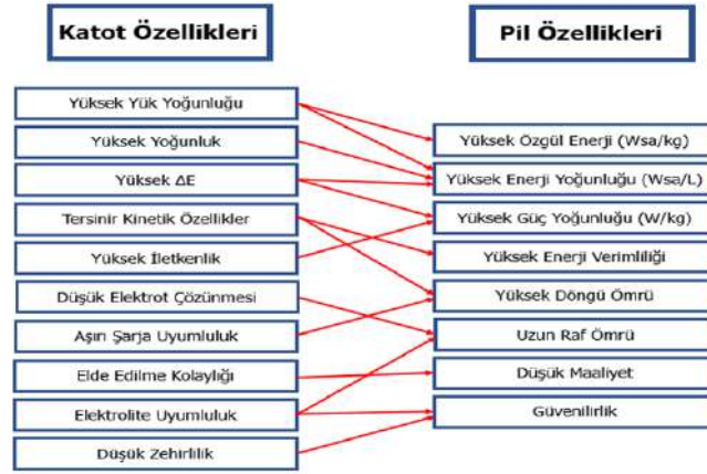
Şekil 6. Katot elektrot aktif malzeme özelliklerinin pil davranışına olan etkisi (Şahan 2009).
