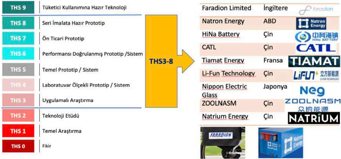
Şekil 10. Sodyum iyon pili mevcut teknolojik hazırlık seviyesi ve ticari uygulamalar
