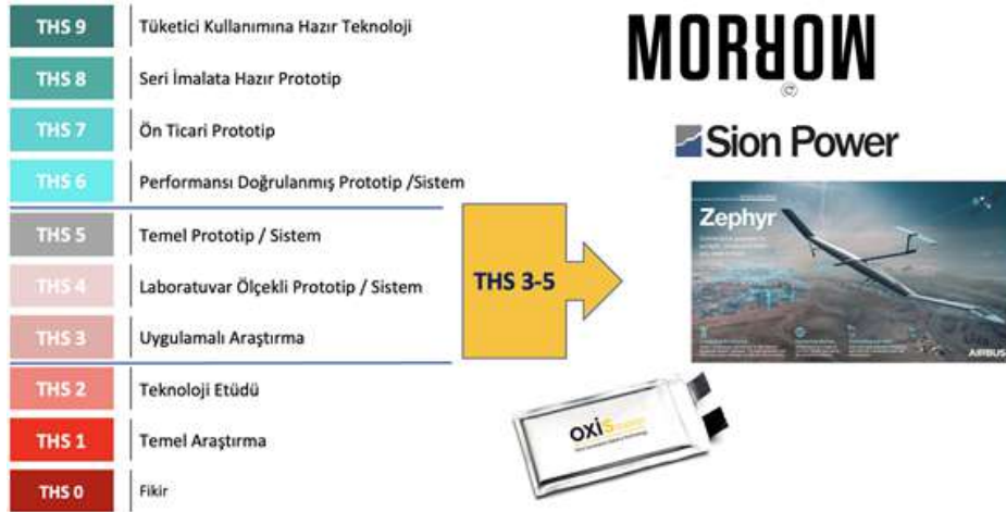
Şekil 5. Lityum sülfür pili mevcut teknolojik hazırlık seviyesi ve ticari uygulamalar.
