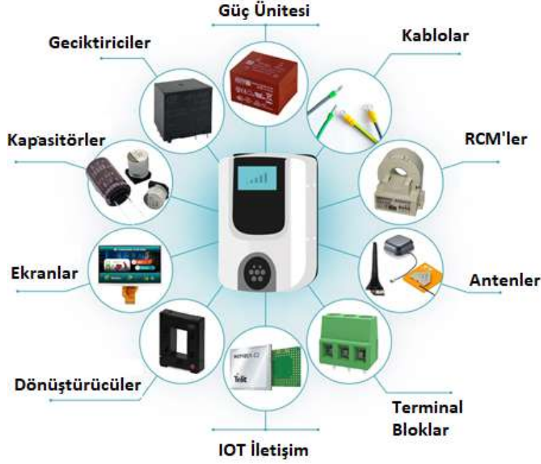
Şekil 3. AC şarj ünitesinin bileşenleri (Tüm hakları Easby Electronics: Leading Electronic Components Supplier & Distributor ait olup kurumdan izin alınarak uyarlanmıştır, Int. Kyn. 2)
