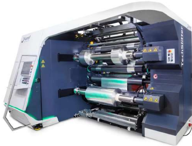
Şekil 16. Dilme makinesi (Kampf firmasının ürün görselidir).
