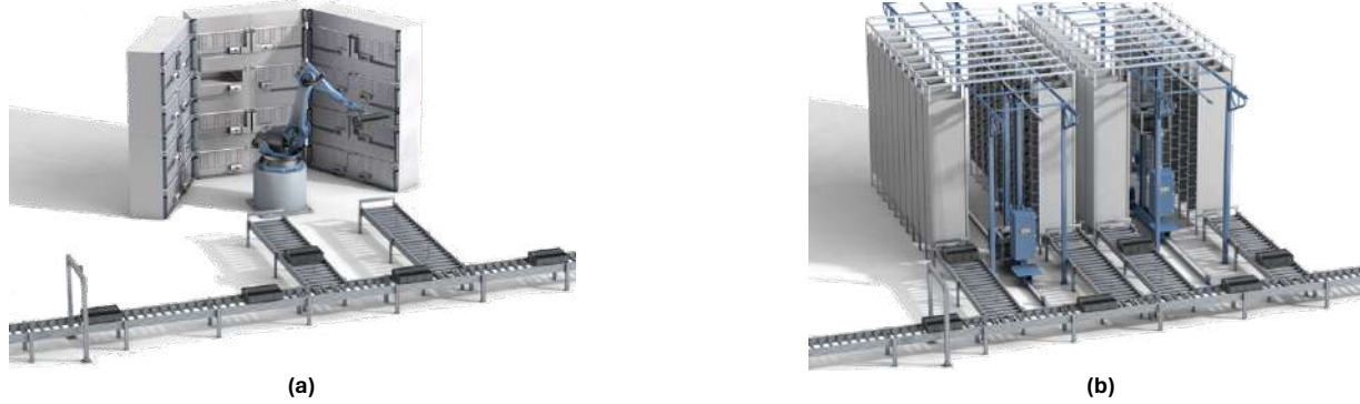
Şekil 26. (a) Hücre tipi robotlu yaşlandırma sistemi. (b) Raf tipi yaşlandırma sistemi (Int. Kyn. 1).
