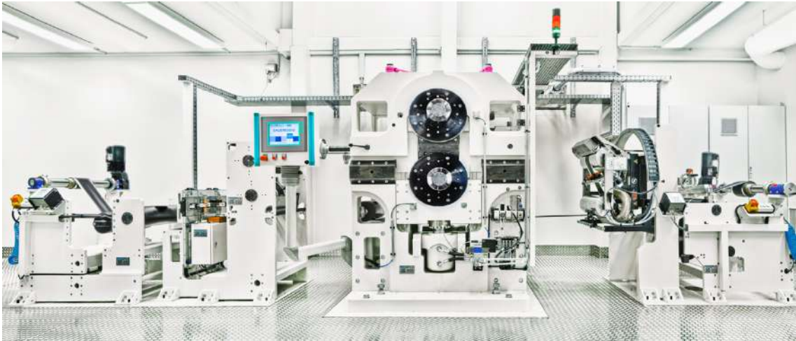
Şekil 14. Elektrot sıkıştırma (haddeme) makinası (Saueressig firmasının ürün görselidir).
