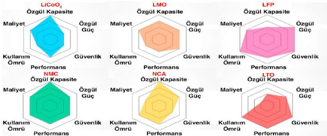
Şekil 5. Katod aktif malzemelerin maliyet, kapasite, güç, güvenlik, performans ve ömür özellikleri (Miao vd. 2019)
