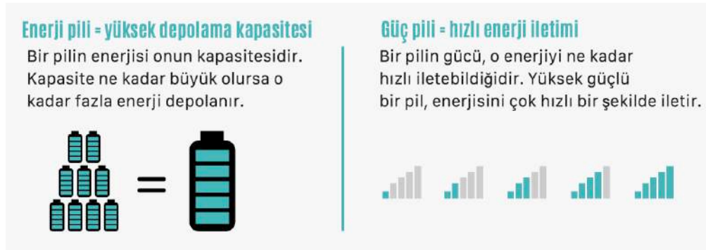
Şekil 2. Enerji ve güç pillerinin karşılaştırılması (Int. Kyn. 1).
